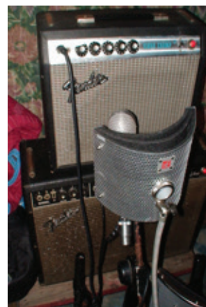
Figure 8 : Les deux amplis Fender (Vibro Champ des années 1970 en haut, Vibrolux des années 1960 en bas), utilisés pour les guitares électriques, dont le son sera capté par un micro RCA (pour le Vibro Champ), un SM57 et un Royer (pour le Vibrolux)
